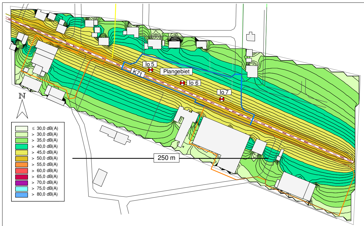
Abb. 5 : Lärmkarte für den Straßenverkehr nachts, Berechnungshöhe 5,5 m.
